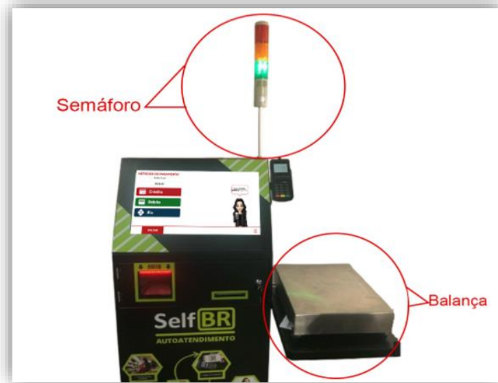
Figura 2: Totem de Autoatendimento com Balança Conferidora e Semáforo Indicador
